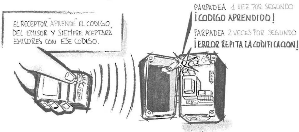
3. Una vez acabada la programación, pulse nuevamente la tecla de PROGRAMACIÓN del Receptor para "cerrar" esta función y volver a la posición de RECEPCIÓN. En ese momento se apagará el diodo.
